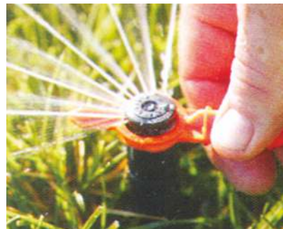
Regulacja kąta zraszania
